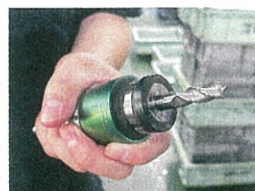
エンドミル加工で、グリーンG1チャックを使用すれば、切削速度を従来比3倍以上上げて大丈夫だと言う
