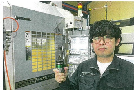
グリーンG1チャックでツーリングの比較検証を実施。ビバリ音の解消や面粗度向上などの結果を得たと語る玉利専務
