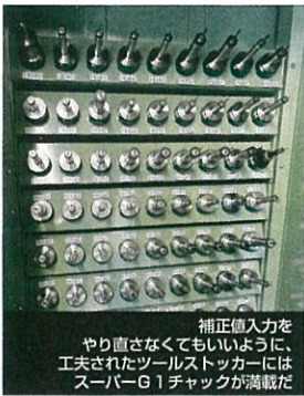
補正値入力や工夫されたツールストックにはスーパーG1チャックが満載だ
