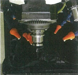
スーパーG1チャックの活用でビブりが解消し、加工の安定性をもたらしたと言う
