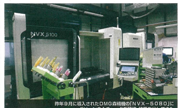
昨年9月に導入されたDMG森精機の「NVX-5080」にグリーンG1チャックを装着、結果を出してきた
