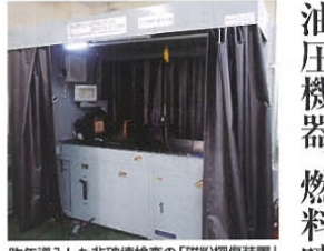
昨年導入した非破壊検査の「磁粉探傷装置」
