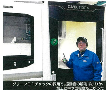
グリーンG1チャックの採用で、振動音の解消ばかりか、加工効率や面粗度も上がった
