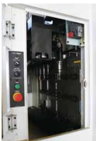
パレットチェンジャーに装填された分を含めスーパーG1チャックはすでに7本取り付けられている
